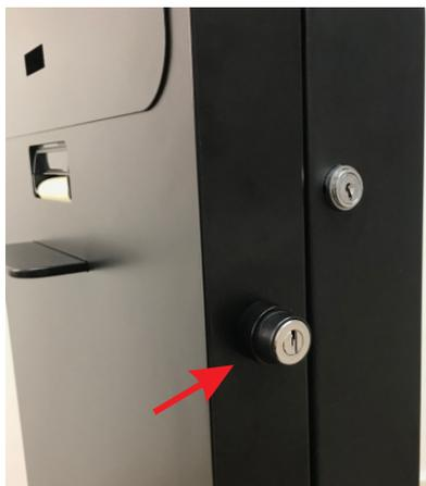
Para ligar o equipamento, introduza a chave na abertura da chave comutadora e gire a chave no sentido horário até a segunda posição, conforme imagem abaixo. O filtro de linha será energizado e, por conseguinte os equipamentos a ele conectados.
